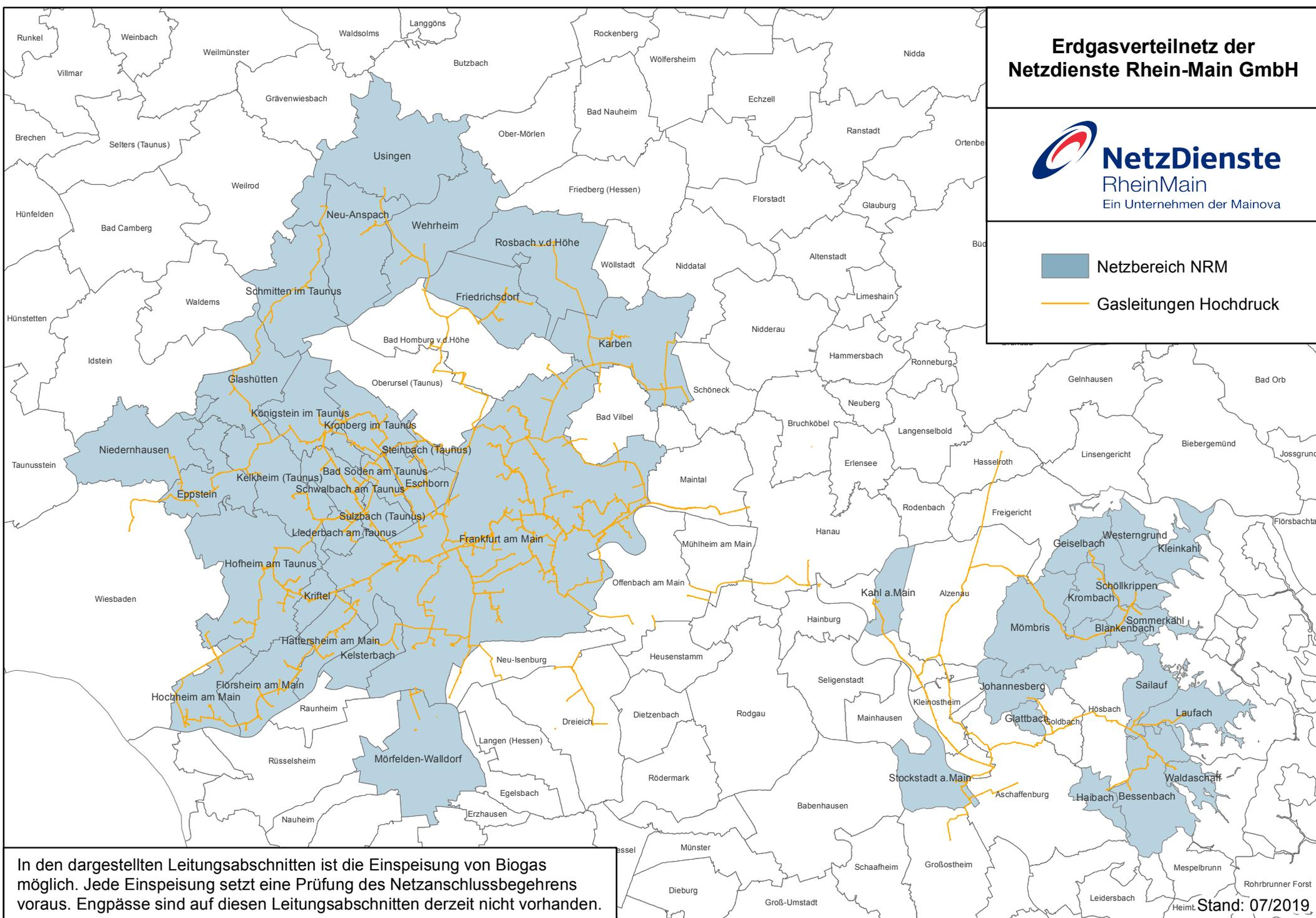
In den dargestellten Leitungsabschnitten ist die Einspeisung von Biogas möglich. Jede Einspeisung setzt eine Prüfung des Netzanschlussbegehrens voraus. Engpässe sind auf diesen Leitungsabschnitten derzeit nicht vorhanden.
