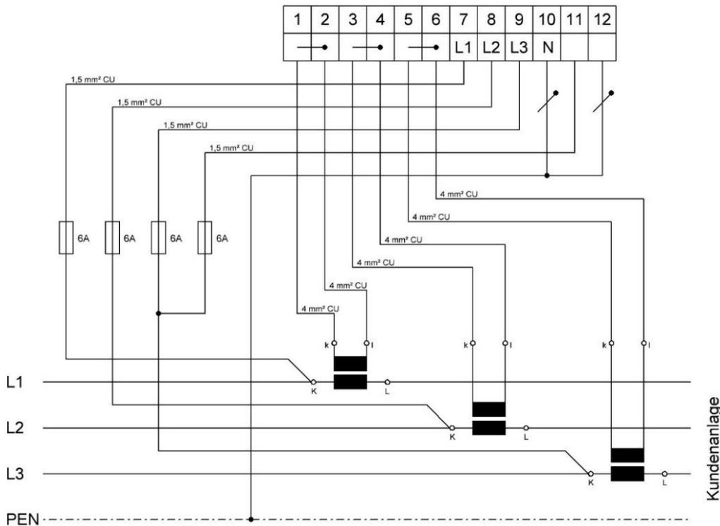
Für die Absicherung der Spannungspfade und zum Schutze einer Spannungsüberwachungseinrichtung und ggf. eines Tarifsteuergerätes sind 4 Sicherungselemente D01, bestückt mit 6 A Sicherungen, oder LS-Schalter 6A Typ Z in unmittelbarer Nähe der Wandler plombierbar anzubringen. Die Prüfklemme ist vom VIU unmittelbar unter dem Zählerfeld zu installieren und wird mit den Messwandlern von der MSD zur Verfügung gestellt.
