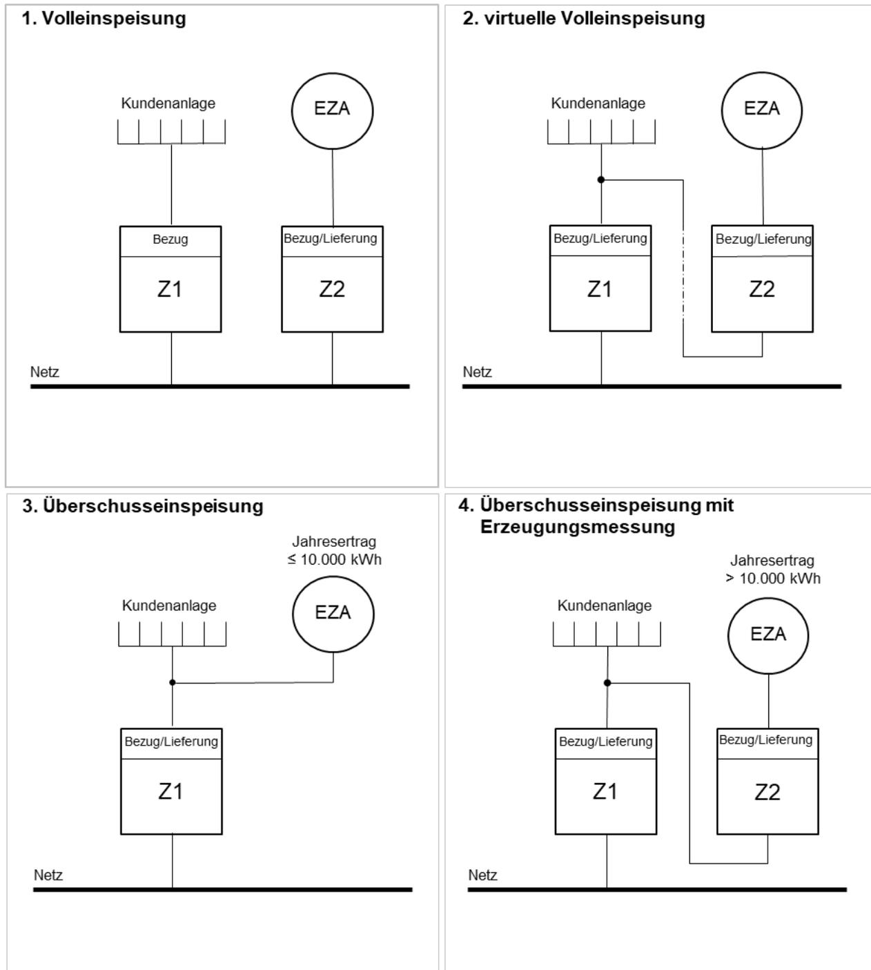
Diese Messkonzepte entsprechen dem FNN-Hinweis „Anschluss und Betrieb von Speichern am Niederspannungsnetz“. Für die Bestätigung der Funktion des Energieflussrichtungssensors (S) gilt das Nachweisverfahren gemäß VDE-AR-N 4105.
