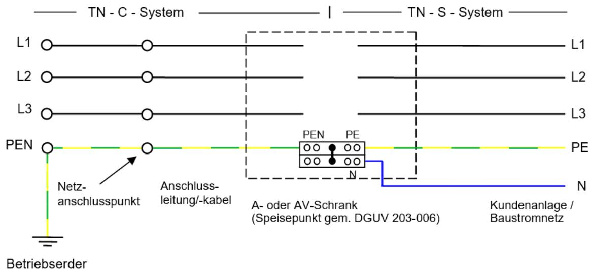
Abbildung 1: Anschlussmöglichkeiten am Beispiel des TN-C-Systems
