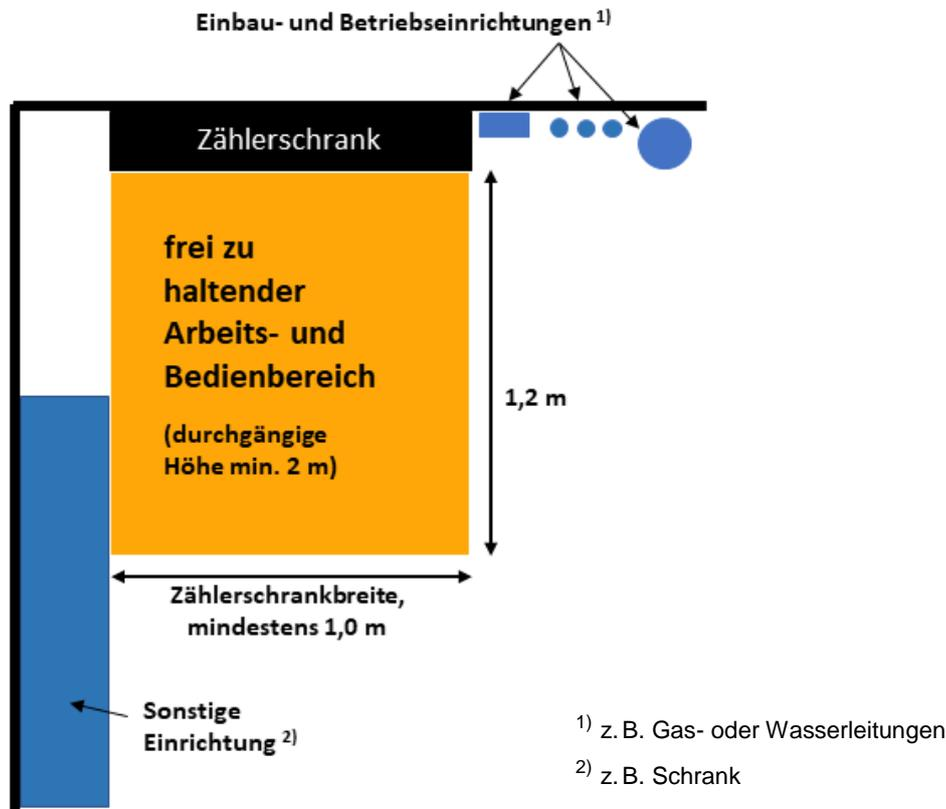
Abbildung 4: Arbeits- und Bedienbereich vor dem Zählerschrank
