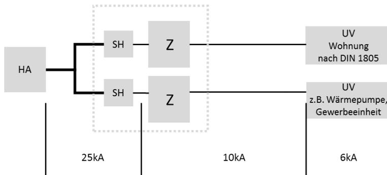
Abbildung 3: Kurzschlusseinrichtungen
