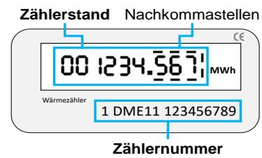
**Wärmemengenzähler:** Bitte Zählerstand mit **MWh** mit **3 Nachkommastellen** angeben.
